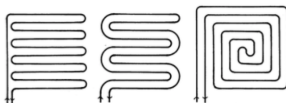
Figur 4.4 Visar tre olika typer av förläggningsmönster enkel förlagd slinga, dubbelförlagd slinga och dubbelförlagd snäckförläggning (Persson, 2000).
